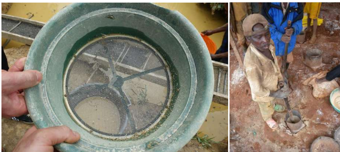
Photos 19 et 20 : Ceci (à gauche) est probablement un maillage approprié pour le minerai de Kafiawema (environ 1 mm), au moins pour le broyage primaire. Les analyses granulométriques indiqueraient mieux la taille optimale. Broyage secondaire au mortier et au pilon (à droite)
