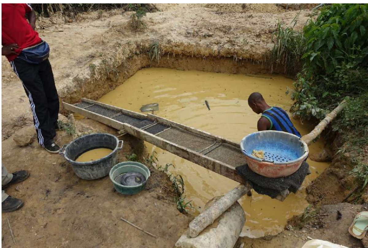
Photo 21 : À Kafiawema, la pente de cette rampe de lavage pourrait être optimisée et les deux sections de la rampe devraient être disposées en configuration L ou Z pour forcer le débit à s'arrêter et à redémarrer (la majeure partie de l'or est prise dans le premier mètre de la rampe, faire un virage rendrait plus efficace la longueur utile de la rampe)
