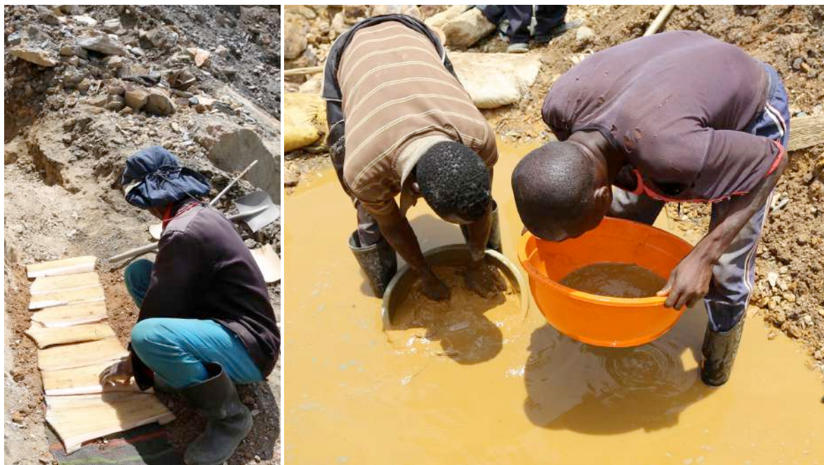
Photos 10 et 11 : L'écorce de banane sert de concentrateur effectif d'or, mais inefficace (à gauche). Des tapis appropriés et moelleux, sur un plan de lavage incliné à 10° seraient plus efficaces pour capturer l'or. Les bassines en plastique servent de concentrateurs d'or relativement pauvres, et les écuelles à or appropriées seraient plus efficaces
