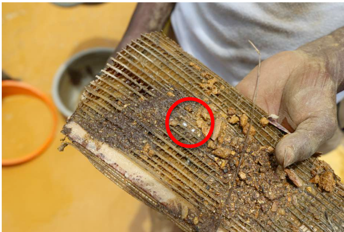
Photo 12 : Gouttelettes de mercure visibles sur l'écorce de bananier
