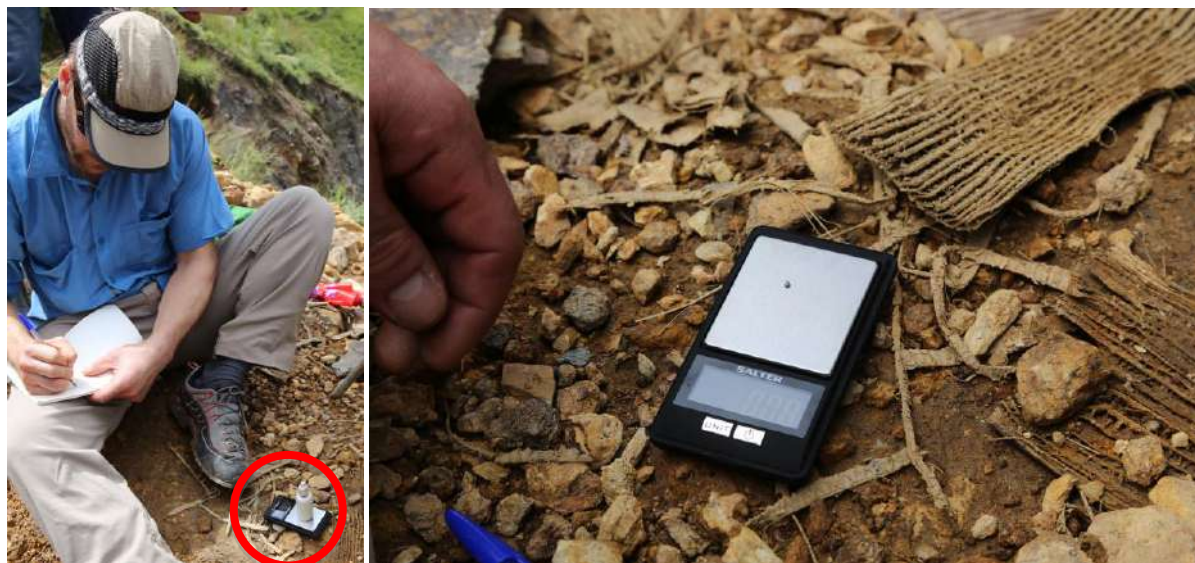
Photo 24 et 25 : Inventaire de mercure utilisant une balance électronique pour mesurer le rapport entre la perte de mercure et l'or produit
