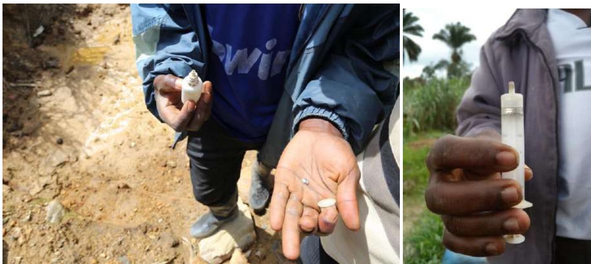
Photos 13 et 14 : Le PDG gère le mercure pour le site, qui est distribué gratuitement aux mineurs, puis recueilli dans la même bouteille ou seringue après que l'excédent soit compressé et sorti de l'amalgame
