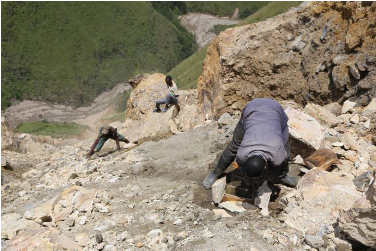
Photo 38 : L'exploitation minière en pente forte est un travail dangereux. Les casques de sécurité et l'utilisation d'équipements de protection individuels manquent
