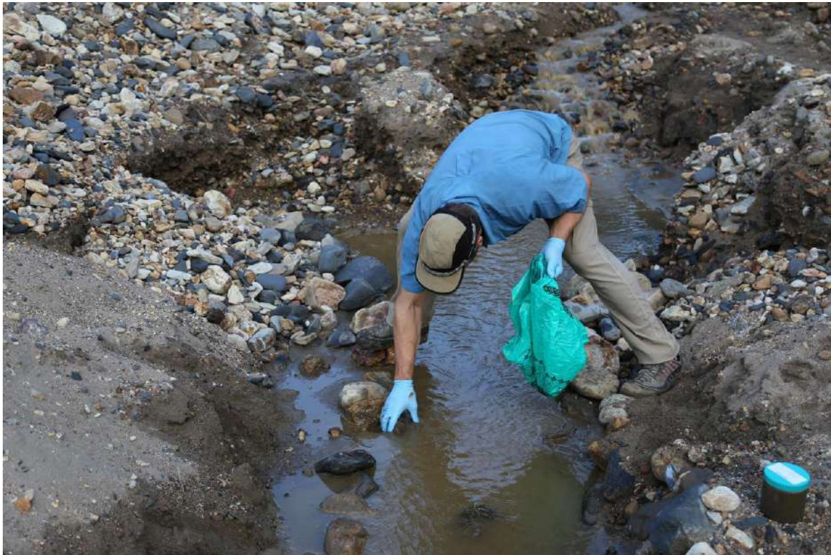
Photo 26 : Prélèvement d'échantillons de sédiments du lit du Luzinzi où se déroule l'exploitation minière alluvionnaire
