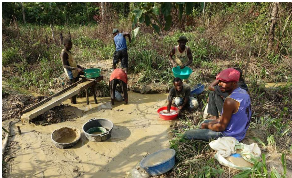
Photo 18 : Retraitement continu des résidus miniers. Notez l'absence d'entreposage organisé de résidus ou de contrôle des effluents
