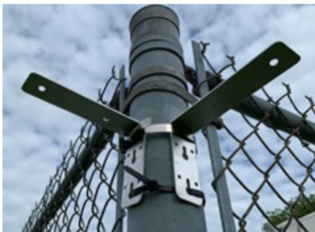
Figure 3. Visualisation des supports de montage pour l'installation des échantillonneurs MerPAS®
