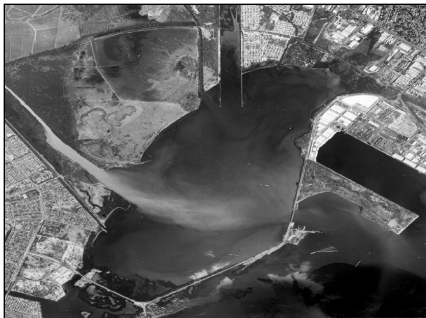
Figure 22. Comportement typique du « panache » de déversement des sédiments en suspension du Cobre dans la baie Hunts, dans le port de Kingston (Jamaïque).
