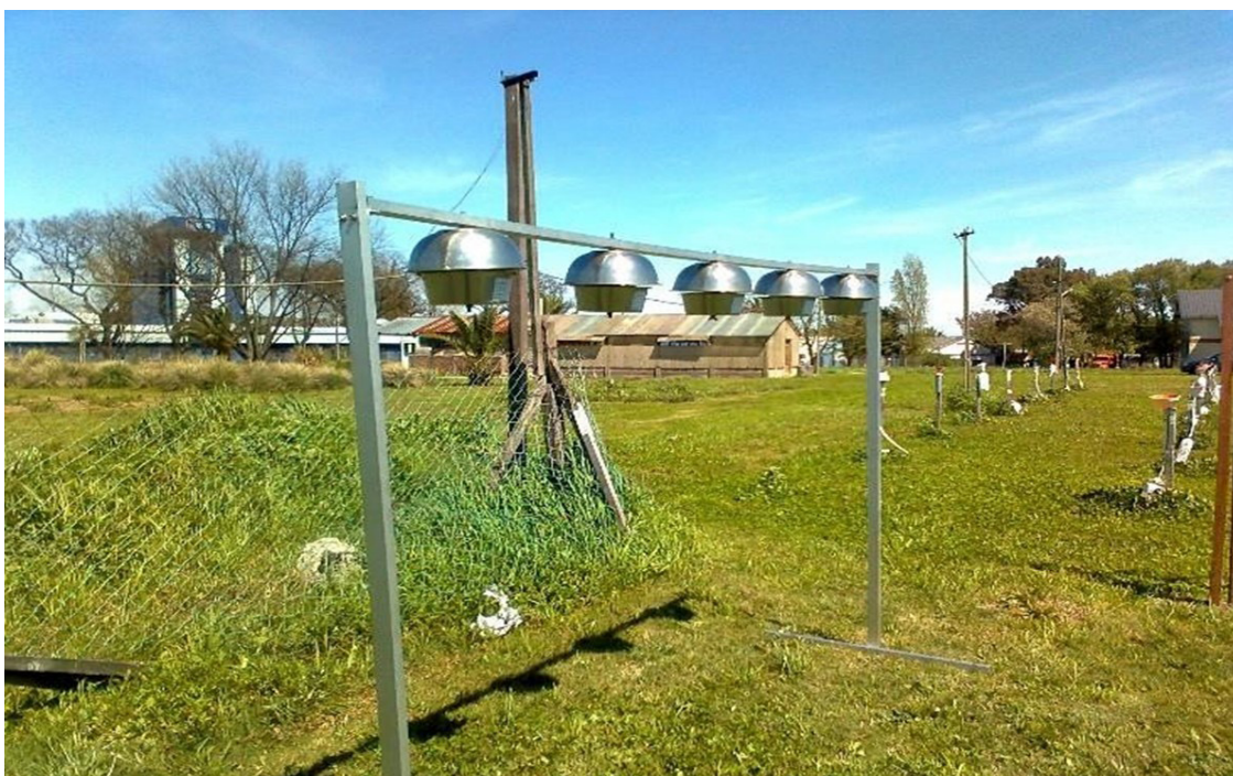
Figura 1. Muestreadores de aire pasivos desplegados en el campo.
